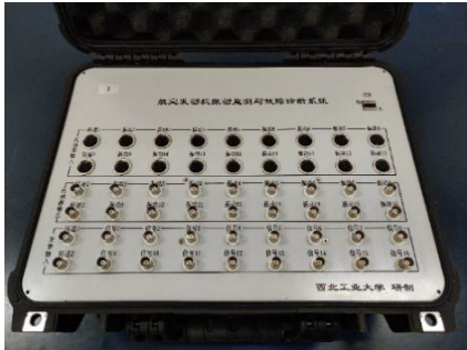
图 7 振动数据采集系统 Fig. 7 Vibration data acquisition system
