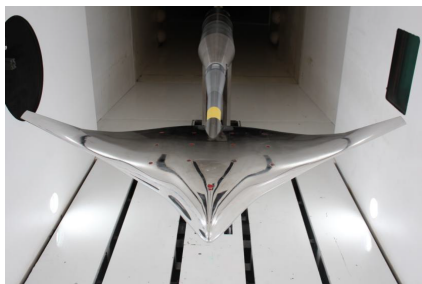
图 4 试验模型在风洞中的安装照片
