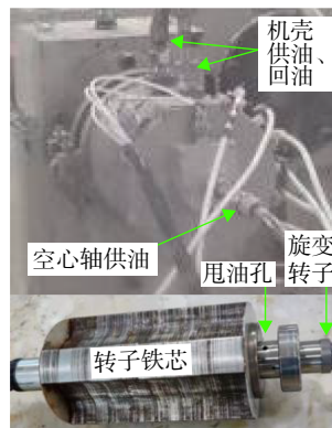
图 28 南京航空航天大学与航空工业电源合作研制的内置式 SR S/G
