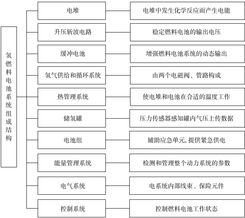
图 1 氢电增程式混合动力系统组成结构
