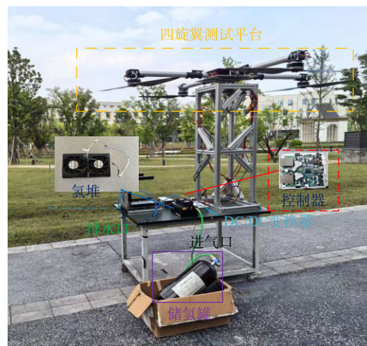
图 13 氢电增程式混合动力多旋翼测试台架实物
