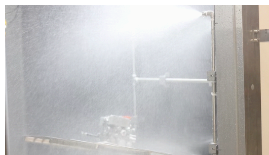
图 30 燃油泵调节器防水试验
