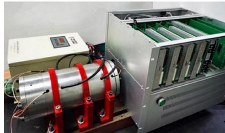
图 16 磁气组合轴承转子系统试验台
